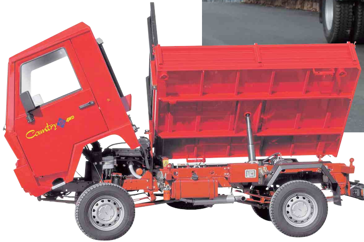
Trattrice agricola Country 330, equipaggiata con motore raffreddato con liquido. La cabina è ribaltabile per consentire una migliore accessibilità e semplificare le operazioni di manutenzione / The Country 330 has a fluid-cooled engine. Its cab can be tipped for improved accessibility and easier maintenance
